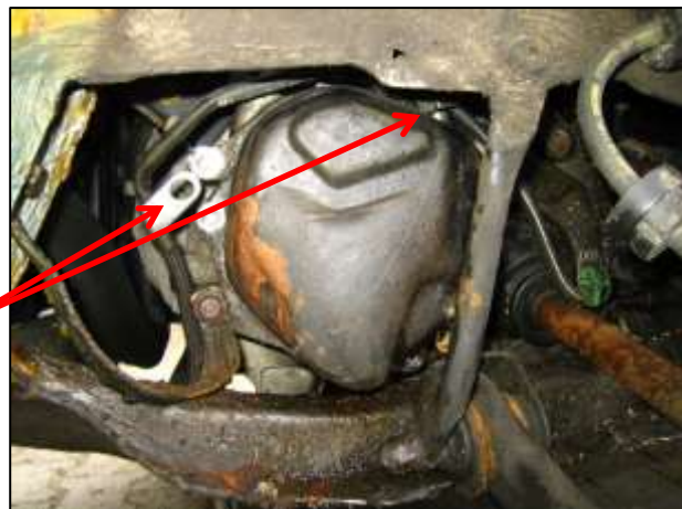
Abb. 5: Schrauben Hydraulikleitung Servolenkung
