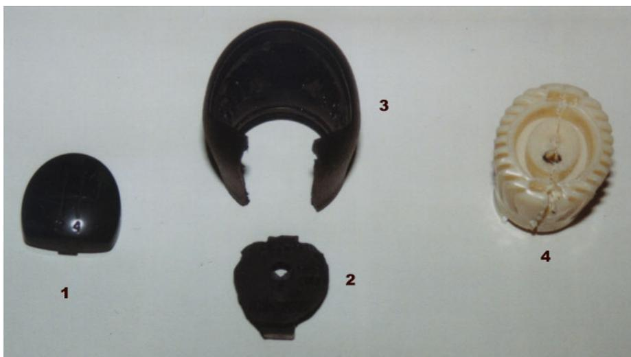
Die Ganganzeige 1 mit Schraubendreher heraushebeln.
