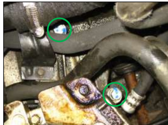
Abb. 2 und 3: Schrauben Getriebelager, Ansicht von Oben
