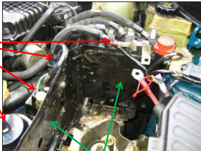
Abb. 1: Bleche Batteriekasten ausbauen
