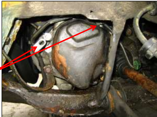
Abb. 5: Schrauben Hydraulikleitung Servolenkung
